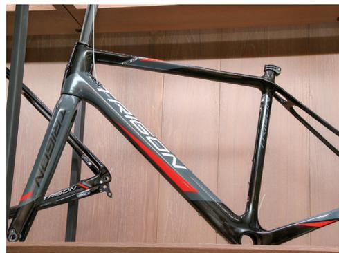
▲Trigon的Gravel碳纖維車架，搭配一體式前叉，有預留土除裝設孔，可裝到40C的輪胎。
