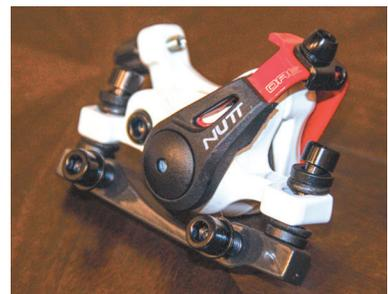
蘭溪捷克展出公路車用碟煞夾器，走內線的機械碟，雙側制動，已獲自行車大廠採用。
